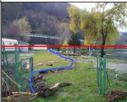
Area ex campeggio di Zenna – Alluvione 2002 – Fonte immagine: IRPI-CNR In blu il livello delle acque raggiunto nel 2002. In rosso il livello raggiunto dal lago nel 2000
